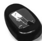
KP 100 snímač bezkontaktních karet s kontrolou vstupů/výstupů
