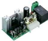
CARICA zásuvná karta pro automatické dobíjení akumulátorů
