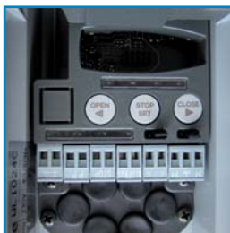
Zabudovaná řídicí jednotka s SM slotem
