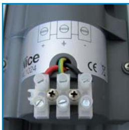
Svorkovnice pro napájení uvnitř druhého pohonu
