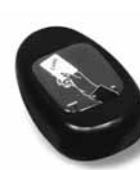
KP 100 snímač bezkontaktních karet s kontrolou vstupů/výstupů
