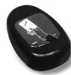
KP 100 snímač bezkontaktních karet s kontrolou vstupů/výstupů
