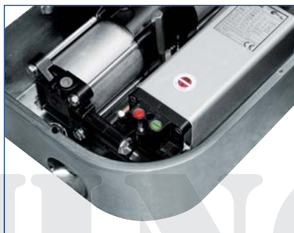
Detail ventilů pro nastavení síly
